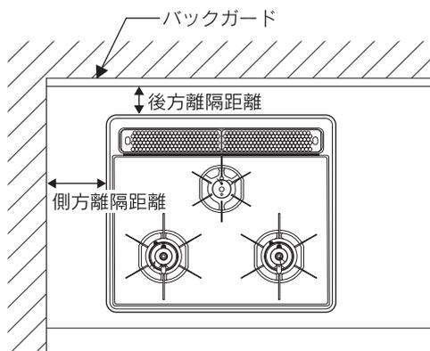
側方はトッププレート端より 150mm（W750 の場合は 75mm）の離隔距離が必要です。後方はトッププレート端より 50mm の離隔距離が必要です（一部の機種は 150mm 以上）。
