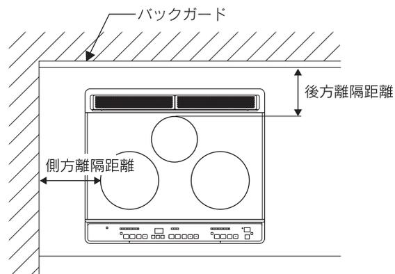
側方は発熱体のリング外周より 100 mm 以上（W750 の場合は 130mm 以上）の離隔距離が必要です。後方は発熱体がラジエントの場合、リング外周より 100mm 以上、IH の場合、リング外周より 130mm 以上離隔距離が必要です。
