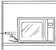
※電子レンジを設置する場合は、機器の取扱説明書に従って設置し、アース線を確実に取付けてください。
